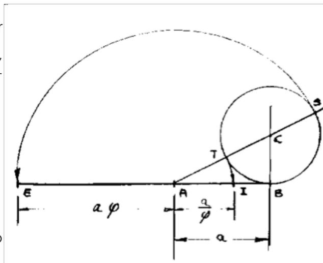
Para dividir un segmento de recta AB en razón media y extrema podemos usar la siguiente construcción (Fig. 4): desde el punto B trazamos la recta BC perpendicular y de tamaño igual a la mitad de AB; con centro en C trazamos la circunferencia de radio AB y trazamos la recta ATCS. AT y AS son los segmentos áureos de AB que abatimos sobre el soporte de la recta AB obteniendo así los puntos I y E de longitudes respectivamente iguales a  $\frac{a}{\varphi}$  (ecuación I)
